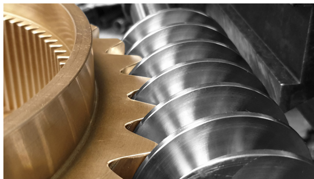
Фото 5. Изготовленная НТЦ «РЕДУКТОР» червячная передача ZT по ГОСТ18498–89 и ГОСТ 19650–97 — аналог немецкой червячной передачи CAVEX
